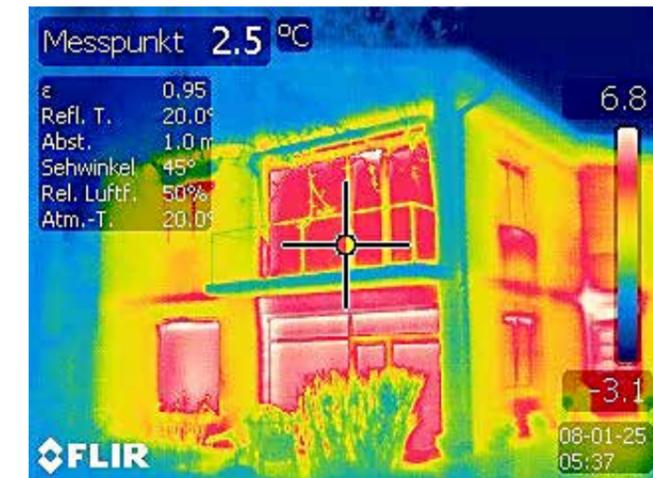
Ein Thermographiebild zeigt Schwachstellen bei einem Haus sehr deutlich auf. An rot eingefärbten Stellen geht sehr viel Wärme verloren, blaue Stellen zeigen sehr geringe Wärmeverluste an.
